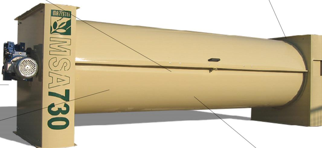
Il punto di raccolta è posizionato come nei vecchi cilindri a ore 9, garantiamo in questo modo una selezione **gravitazionale** senza l'interferenza della forza **centrifuga** che può raccogliere prodotto di grandezza diversa da quella contenibile dall'alveolo
